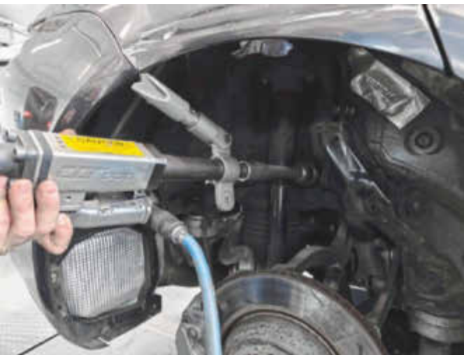
Wichtiger noch als bei Stahl-Karosserien ist, dass die Deformation so weit wie möglich mit der CBR-Klebeteknik und der Push-Pull-Pressen vorgerichtet wird. (Foto: Carbon)
