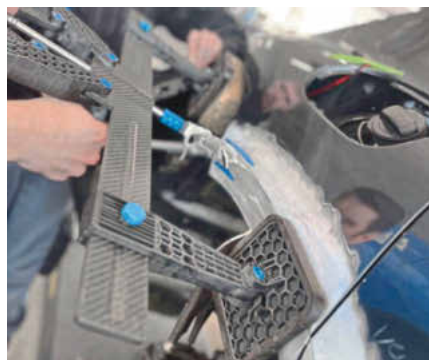
Beim Rückverformen mit den CBR-Zugwerkzeugen wird der Aluminiumwerkstoff gezielt auf einen bestimmten Temperaturbereich gebracht.
