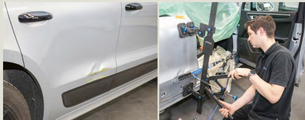
Für Fahrzeug, Instandsetzer und Wagenbesitzer war die Reparatur der beschädigten Tür am Porsche Macan eine echte Win-win-win-Situation. Das Resultat der Schichtdickenmessung zeigt kaum Unterschiede zu den werkseitig lackierten Bereichen. Beleg dafür, dass in der Lackvorbereitung so gut wie kein Spachtel und Füller nötig waren.
