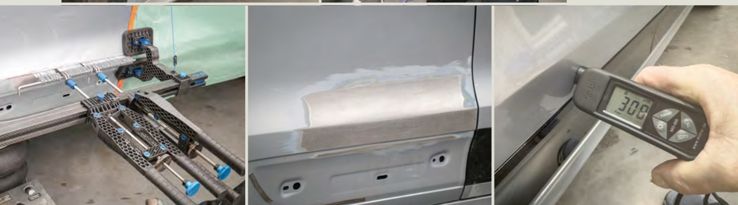
Für Fahrzeug, Instandsetzer und Wagenbesitzer war die Reparatur der beschädigten Tür am Porsche Macan eine echte Win-win-win-Situation. Das Resultat der Schichtdickenmessung zeigt kaum Unterschiede zu den werkseitig lackierten Bereichen. Beleg dafür, dass in der Lackvorbereitung so gut wie kein Spachtel und Füller nötig waren.
