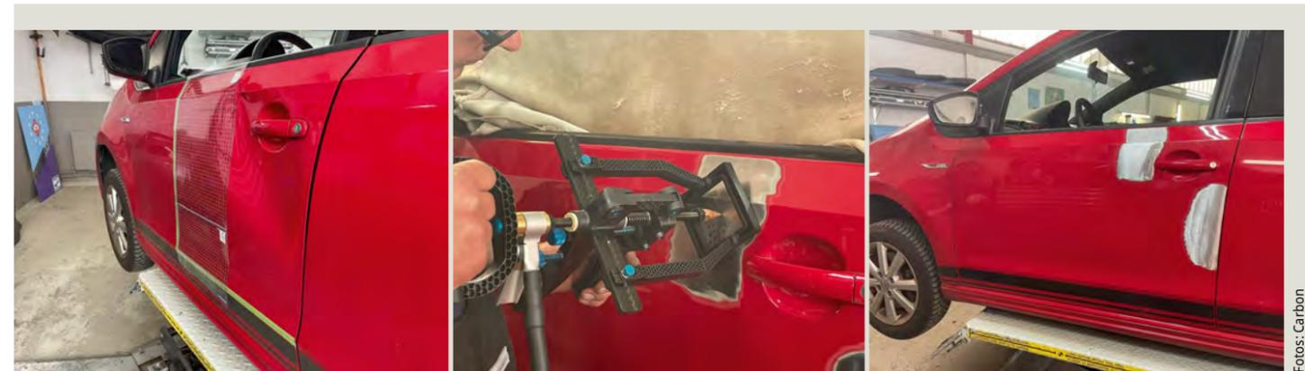
System-Einweisung mit „Aha-Effekt“: Wie so oft, wollten die Mitarbeiter die beschädigte Tür austauschen. Die Carbon-Techniker demonstrieren an solchen Schäden gerne, dass selbst Anbauteile problemlos und schnell repariert werden können. Weil die zu lackierende Fläche klein ist, bleiben auch die Kosten für die Lackier Vorbereitung und Material weit unter denen eines Tauschteils, egal ob neu oder gebraucht.
