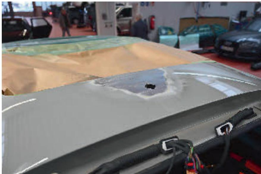
Eine klassische Anwendung für das CBR-System: Antennenausriss mit massiver Verformung des Dachs. Statt eines Austauschs der Dachhaut wurde das Blech sanft in Form gezogen.
