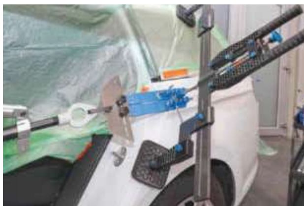
Die Klebtechnik als erster Schritt hilft sehr dabei, die Verformung und die Spaltmaße wieder näher zum Ursprung zu bringen.
