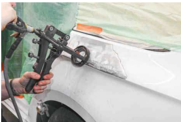
Vor der Übergabe an die Lackvorbereitung muss die Fläche mit dem EasyTool-Werkzeug und dem CBR-MultiTool mit Einziehelektrode zum Finish gebracht werden.
