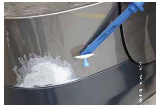
Nach der Rückformung des Blechs lassen sich die Klebepads ohne Spuren entfernen und anschließend wiederverwenden.
