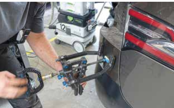
Vor allem runde Verformungen ohne Karosseriekanten lassen sich durch die Klebepads weich und schonend herausmassieren.
