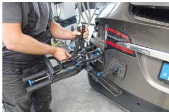
Bei Bedarf lassen sich auch mehrere Pads verkleben und gleichzeitig mit mehreren Werkzeugen bearbeiten. Hier ist die Kreativität und Erfahrung des Karosseriebauers gefragt.
