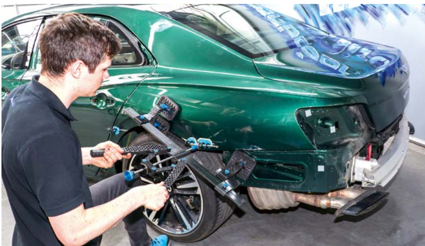
Pflichtwerkzeug: Die wiederverwendbaren Zugpads der CBR-Klebetchnik ermöglichen hohe und flächig wirksame Zugkräfte. Diese sind notwendig, um das Aluminiumblech vorzurichten.
