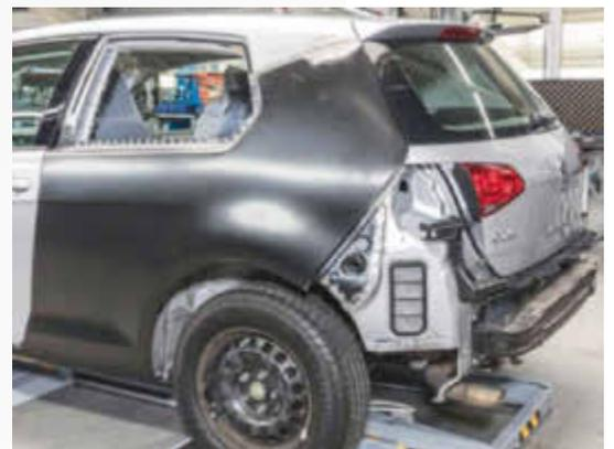
Reparatur versus Neuteil: An dieser Golf-Seitenwand hat die Carbon GmbH beide Varianten durchgerechnet.
