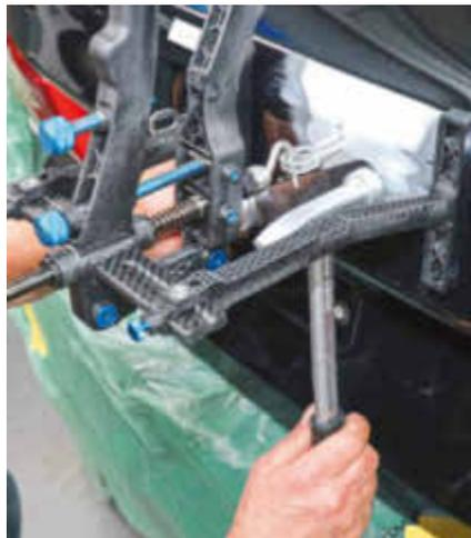
Die hohen Ersatzteilkosten rechtfertigen auch die Instandsetzung dieser Teile.
