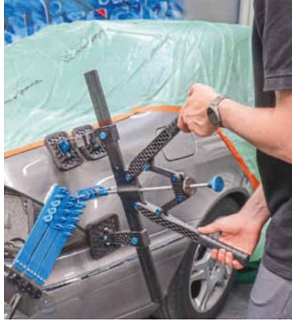
Für ein perfektes Finish sorgt das CBR-EasyTool, mit dem an der Fläche sehr gefühlvoll gearbeitet werden kann. (Fotos: Carbon GmbH)
