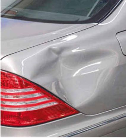
Selbst massive Deformationen wie an dieser Seitenwand können mit der CBR-Klebetchnik und den Zugkomponenten gerichtet werden.
