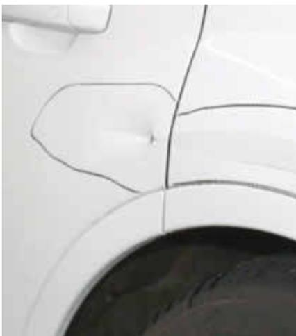
Tür und Seitenwand aus Aluminium lassen sich mit der CBR-Klebertechnik, dem AluRepair-Visar mit Aluminium-Bits und den CBR-Zugwerkzeugen effizient und äußerst profitabel richten.
