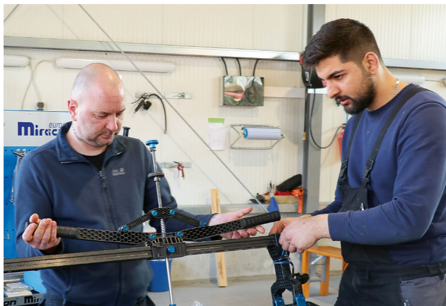
Im direkten Vergleich kein Vergleich: Die aus Carbon gefertigten Werkzeuge des CBR-Systems, wie hier das LineTool zum Richten langer Kanten, sind in der Handhabung ungleich leichter als übliche Richtwerkzeuge und meist problemlos von einem Mitarbeiter allein einsetzbar.
