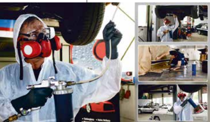
Die Geräte von Sata arbeiten zur Hohlraumkonservierung mit druckbeaufschlagtem Material und Luftzerstäubung.
