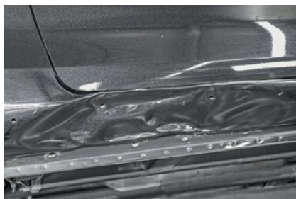
Flexibles Setup: mit dem 1600er Line-Tool und drei Zugeinheiten sowie dem Strong-Tool kann der Anwender diesen Schwellerschaden schnell und gezielt richten.
