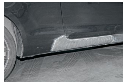
Flexibles Setup: mit dem 1600er Line-Tool und drei Zugeinheiten sowie dem Strong-Tool kann der Anwender diesen Schwellerschaden schnell und gezielt richten.
