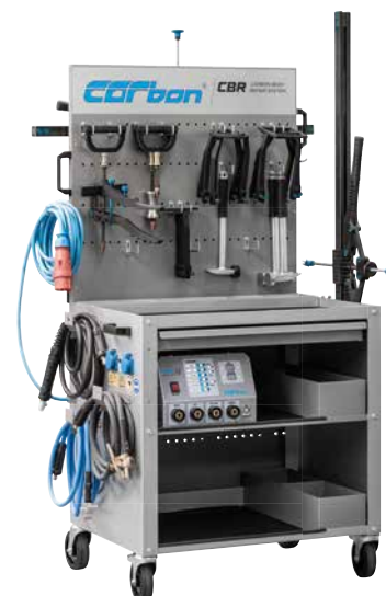
Alles in bester Ordnung: der neue, übersichtliche Systemwagen mit Schublade und Kabelhaltern ermöglicht schnellen Zugriff auf die Zugkomponenten, Verlängerungen und das umfangreiche Zubehör des CBR-Reparaturkonzepts.
