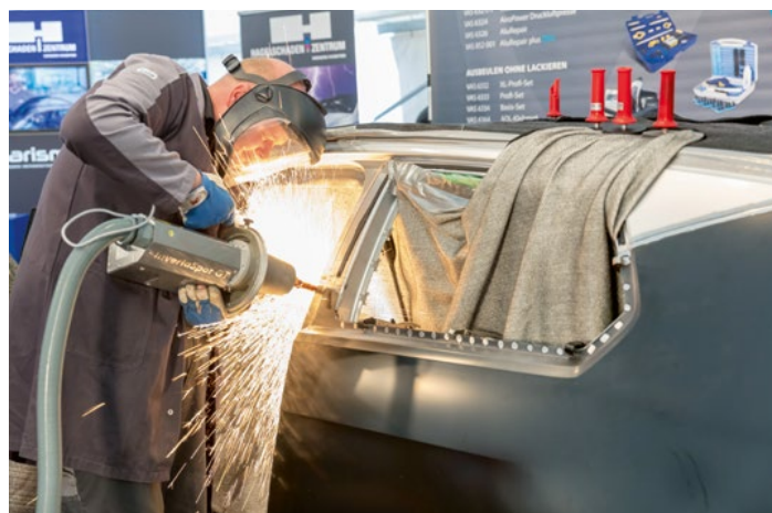
Sichtbar anstrengender: Ralf Rathmann beim Punkten der Seitenwand mit der InvertaSpot GT von Wieländer+Schill
