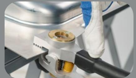
**Multi-Ground-Masseklemme** für optimalen Masseschluss. Die Klemme wird entweder am blankgeschliffenen Blech angeklemt oder mit dem Schweißprogramm „Masse“ mit Hilfe der Elektrode im EasyTool oder der Bithalteelektrode automatisch angeschweißt. Nach Ende der Arbeiten löst man die angeschweißte Klemme einfach durch Drehen der Schweißspitze ab.
