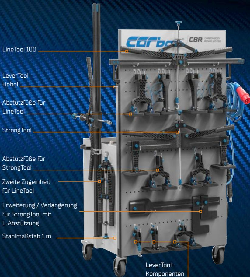
Das CBR-021 ist der ideale Einstieg in die effiziente und hochwertige Reparatur von Außenhautschäden. Den CBR-Systemwagen haben wir konsequent weitergedacht und durch eine Systemschublade sowie zusätzliche Halter erweitert. Am Wagen sind alle Zugwerkzeuge und Zubehörteile übersichtlich organisiert und stets griffbereit. So macht das Arbeiten Spaß!
