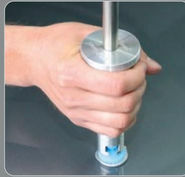
Durch die Kegelform der Zugbolzen und der Aufnahme am Zughammer wird auch bei nicht 100%-ig vertikalem Zug eine optimale Kraftübertragung und Wirkung erreicht.
