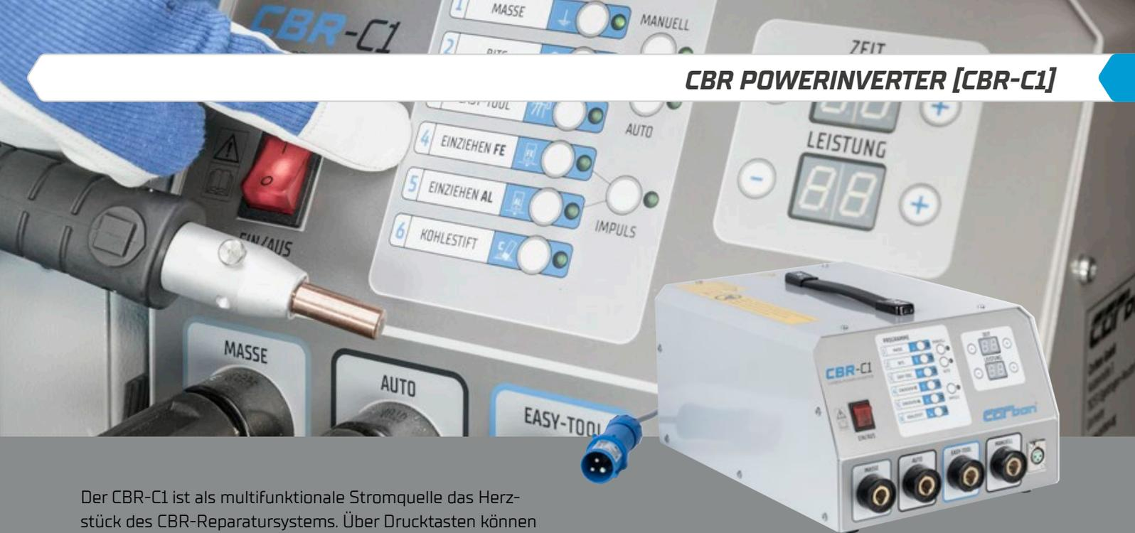
Der CBR-C1 ist als multifunktionale Stromquelle das Herzstück des CBR-Reparatursystems. Über Drucktasten können intuitiv die sechs Grundprogramme angewählt sowie die Einstellung für Schweißzeit und Leistung eingestellt werden.
