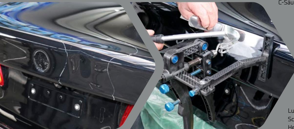
Lukrative Reparatur von Schraubteilen, wie z.B. diese Heckklappe aus Aluminium
