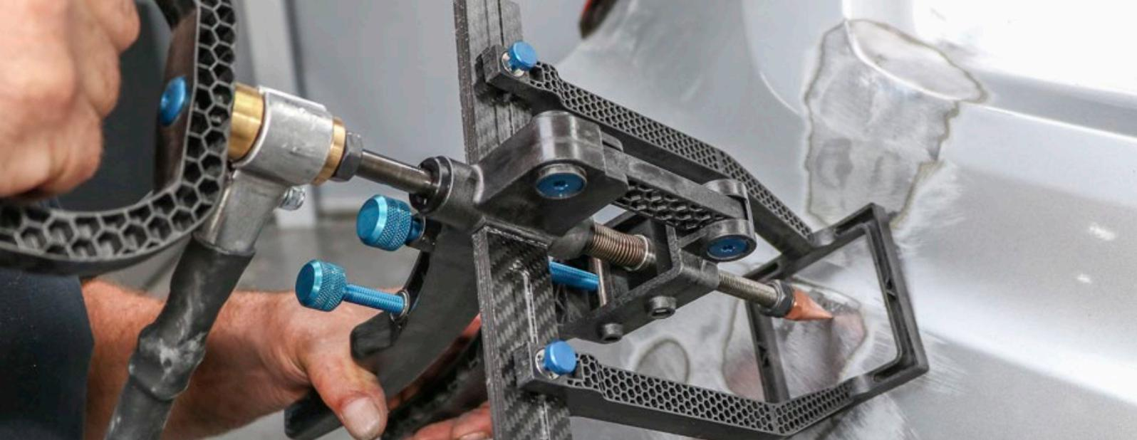
Bei diesem Werkzeug macht sich der enorme Gewichtsvorteil der CBR Zugkomponenten ganz besonders bemerkbar. In Verbindung mit der sehr guten Ergonomie ermöglicht das CBR EasyTool schnelles, präzises und ermüdungsfreies Arbeiten, sowohl bei Finish-Arbeiten, als auch bei der Beseitigung von Streifschäden und Parkdellen.
