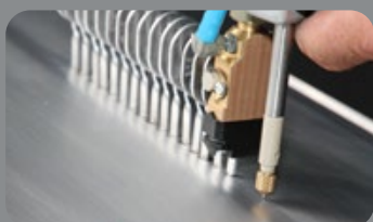
Speziell legierte Alu-Bits anschweißen
