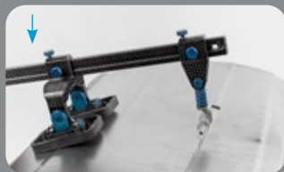
Einsatz mit Doppelfuß beim Drücken
