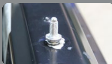
Gewinde- und Massebolzen aus Stahl / Alu bis zu Ø12 mm setzen
