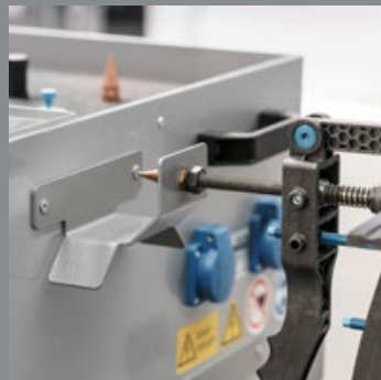
Wechselmöglichkeit der Spitze am Systemwagen
