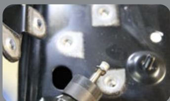
Spezial-Zugbolzen für das Ziehen von Stanznieten schnell und sicher aufschweißen. [Separates Zugwerkzeug erforderlich]
