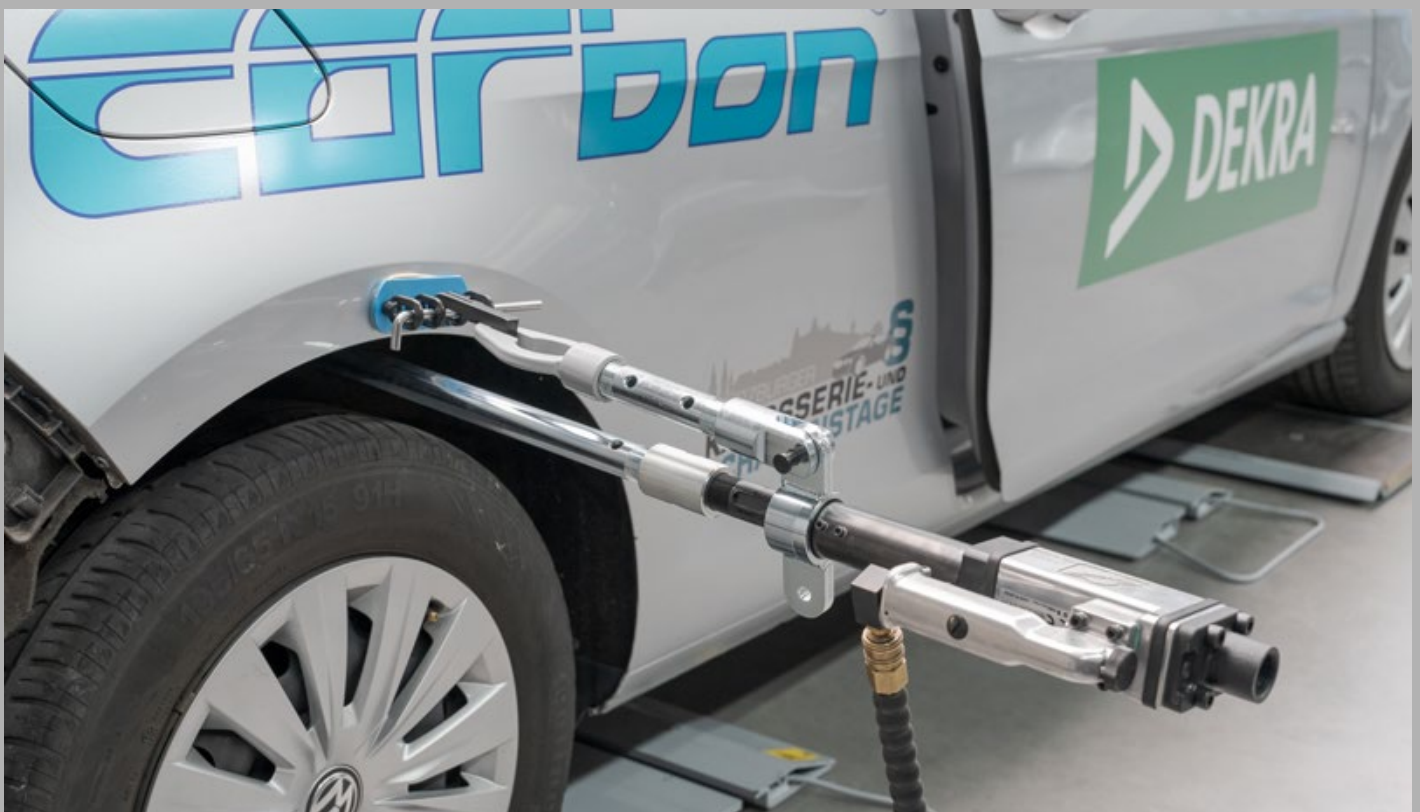
Stellung "4": Hohe Luftmenge, schnelles Aus- / Einfahren des Pressenzylinders
